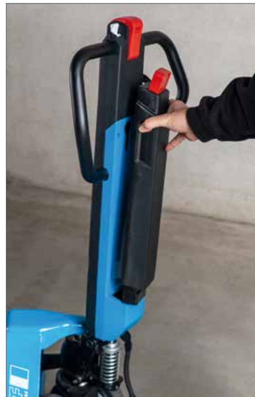
Sekundenschneller Akkuwechsel -- mit einem Handgriff
