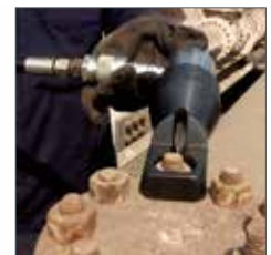
Mutternsprenger YNS/YNS-AH, SW 11-89 mm
