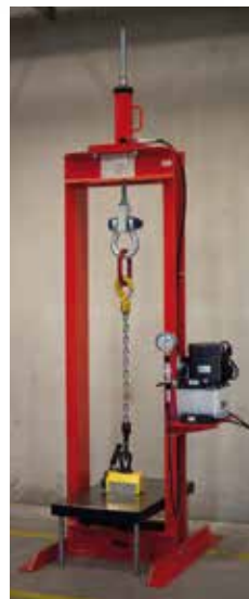
Lasthebemagnet TPM 0,3 zum Belastungstest im Prüfstand RPYS-1215 mit Prüfplatte für Permanentmagnet AYP-1215-S
