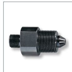
Optional: Gewindeadapter, Modell: FY-201 (M22x1,5 auf G 1/4).
